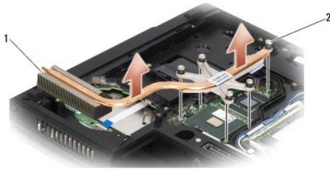
1 E5400-suorittimen jäähdytyslementti 2 kiinnitysruuvit (5)
